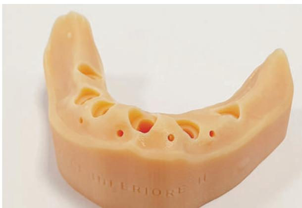
FIG. 9 - Modello stampato 3D con i fori per gli analoghi digitali
