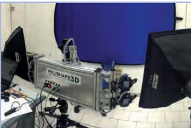
Fig. 7 - Scanner facciale Face Shape Maxi della Polishape 3D (Bari)
