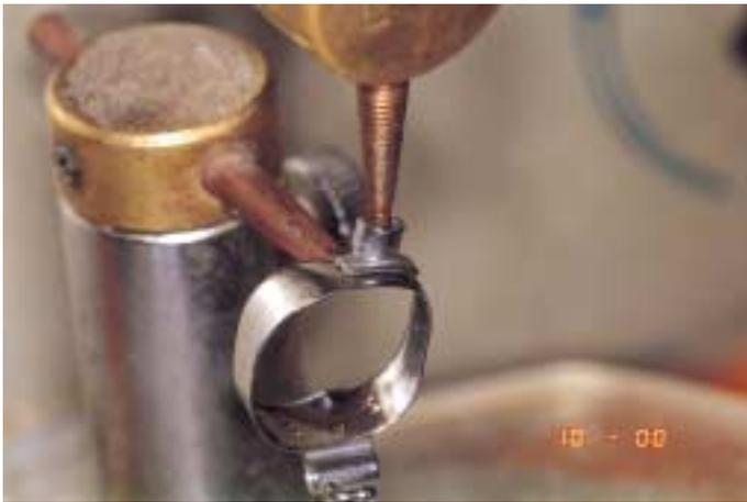
Fig. 2 - Unione tramite puntatrice dei connettori alle bande
