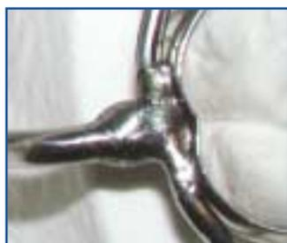
*Aspetto del giunto saldato laser: l'utilizzo del connettore assicura l'integrità del braccio e della banda a garanzia di una perfetta saldatura*
