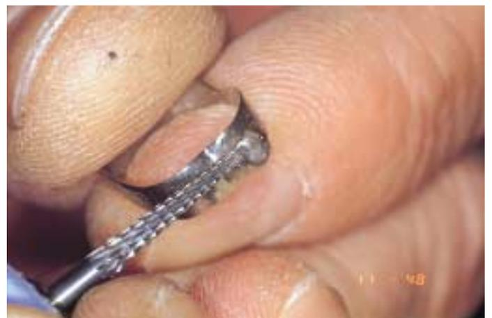
6 - Preparazione della tacca per alloggiare i bracci di collegamento (la traccia si esegue con fresa di tungsteno cercando di creare un incavo di circa 0,9 mm)
