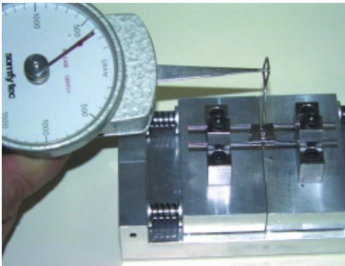
*Fig. 4, 5 e 6 - Test per verificare la frizione in apertura dell'espansore A2620-07. Il dinamometro collegato alla chiave dimostra che la forza necessaria all'apertura (e che, conseguentemente, si oppone alla chiusura) è costante dall'inizio alla fine dell'attivazione.*
