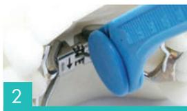
2 Inserire la chiavetta con stop nel foro della vite individuato
