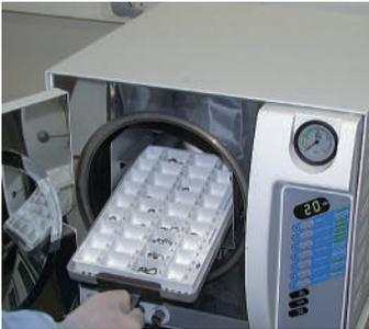
Todas las bandejas pueden esterilizarse en autoclave para limitar el riesgo de infecciones.
