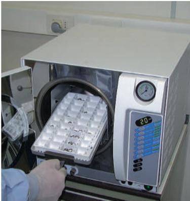
Todas las bandejas pueden esterilizarse en autoclave para limitar el riesgo de infecciones.
