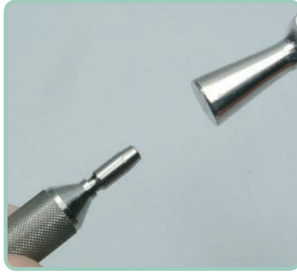
3.4 Colocación del pilar en el mango para pilares, prestando particular atención a encontrar el encaje en el hexágono interno. El mango facilita el fresado del pilar, evitando daños al mismo así como problemas de recalentamiento y sujeción inestable.
