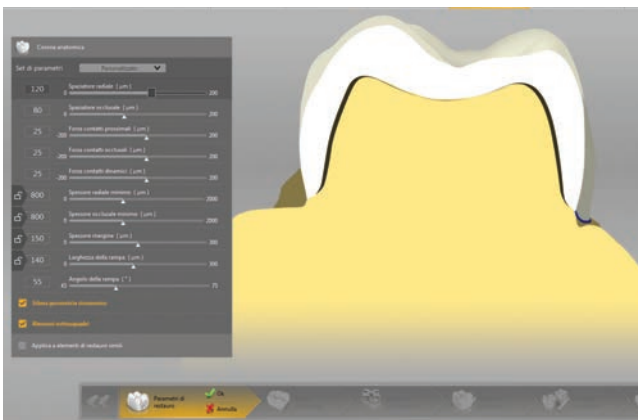
Fig. 11a-b - Progetto CAD mettendo spessori per la cementazione di almeno 120 micron per garantire una buona passività
