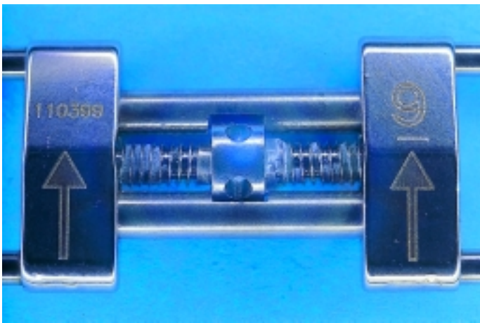
Figg. 1, 2 - La vite A0620 Leone chiusa ed aperta: sono visibili la vite maschio, i corpi con i bracci saldati laser, le guide. Tutti i componenti sono costruiti con tolleranze strettissime, con dimensioni e materiali idonei alla terapia ortopedica. Particolare importanza clinica ricopre la frizione in apertura che evita la disattivazione spontanea durante la terapia; a tal fine la vite Leone viene trattata con uno speciale agente frizionante visibile sulla vite maschio
