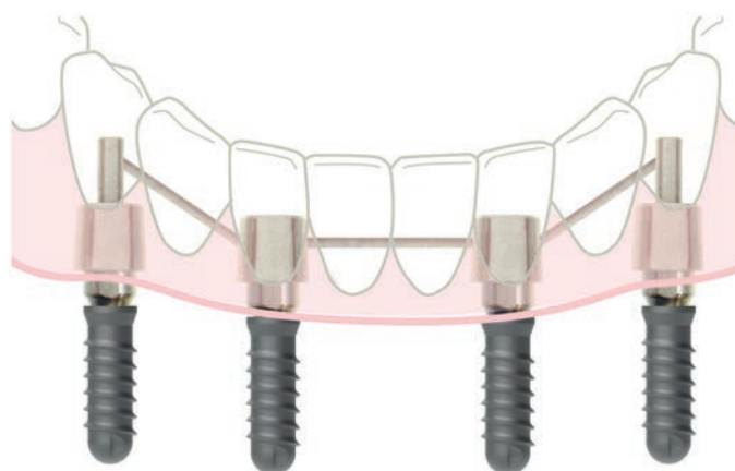
Fig. 117b: Tecnica di saldatura intraorale su cappette WELD.
