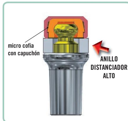
**8.8b** El anillo distanciador **ALTO** se utiliza para fijar en la prótesis la micro cofia con capuchón en eje con la cabeza del pilar.
