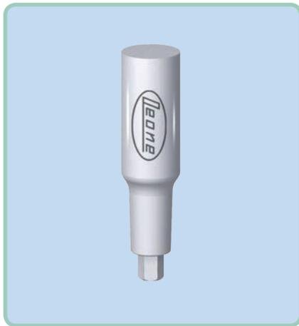
**12.1** Pilar provisional cilíndrico de PEEK. Se puede observar que el tramo de conexión es similar a lo de los pilares definitivos de titanio, con conexión como Morse y hexágono interno.
