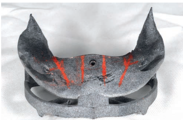
Fig. 7 - Modello 3D dell'inferiore (nylon sinterizzato Laser)
