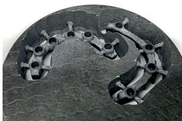
Fig. 47 - Realizzazione delle strutture delle protesi in fibra di carbonio
