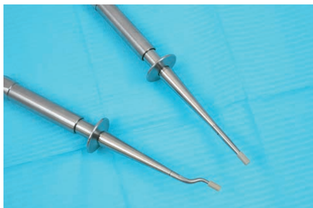
Fig. 43 - Percussore con punta diritta e curva in PEEK
