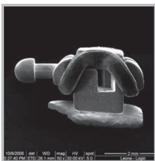
Fig. 5 - Al microscopio appare ancora più evidente come si trasforma lo slot del bracket utilizzando la legatura Slide
