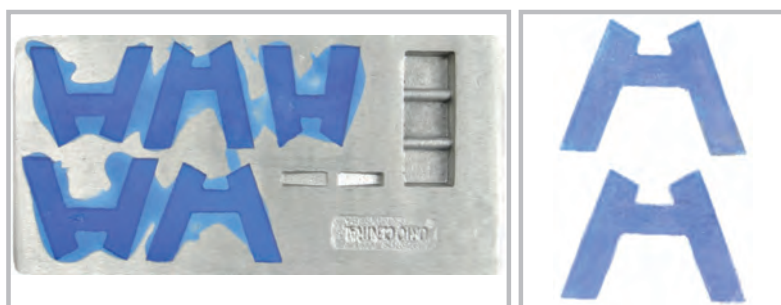
Figg. 16a, b - Resinatura nello stampo e polimerizzazione delle piste preformate
