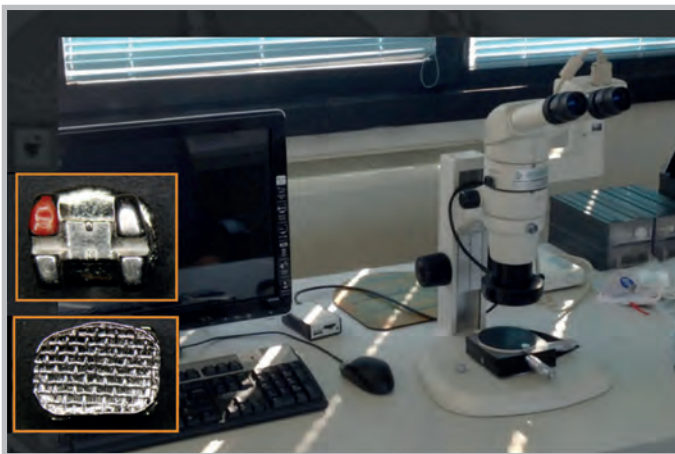
Fig. 4 - Microscopio ottico Nikon SMZ800 è un sistema di ingrandimento che sfrutta la luce con lunghezza d'onda nel range dall'infrarosso all'ultravioletto. Si avvale di una sonda che permette di superare il limite risolutivo legato alla diffrazione (0,2 micron)
