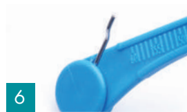
6 Comprobar que la llave haya llegado al tope sobre la extremidad circular del mango
